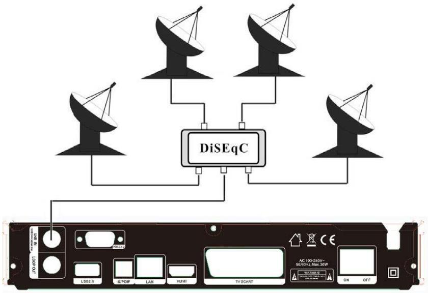
**Abbildung 7. Verbindung mit LNB mit Hilfe von DiSEqC**
